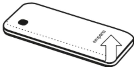
Akku-Deckel abheben – beginnen Sie bei der Ausnehmung an der linken unteren Ecke des Akku-Deckels.
