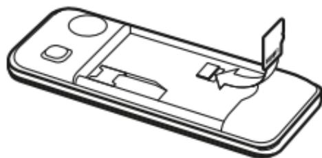
Data Card mit den Goldkontakten nach unten in die Kartenhalterung schieben. Zum Entfernen von SIM-Karte oder Data Card den Sicherungshaken nach unten drücken.
